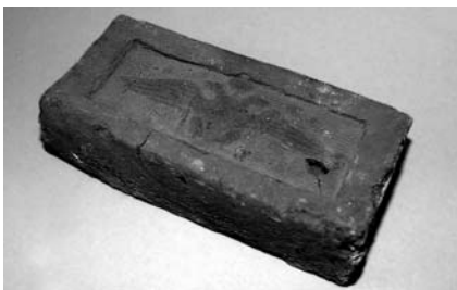
Керамический кирпич Петергофского завода выпущен в последней четверти XIX в. Размер кирпича 250×120×60 мм. Специальное клеймо ставилось на продукцию, предназначенную для строительства государственных учреждений
