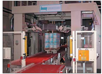
Упаковка палет с расфасованными ССС и жидкими и пастообразными продуктами осуществляется на одной автоматизированной линии
