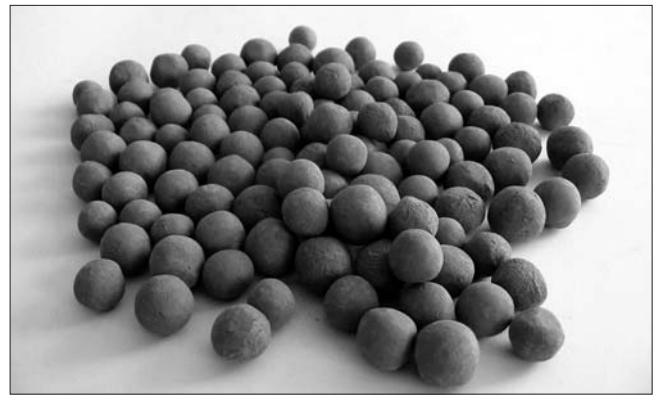
Рис. 2. Фотографии искусственного пустотелого заполнителя на основе торфа и минерального сырья (общий вид)
