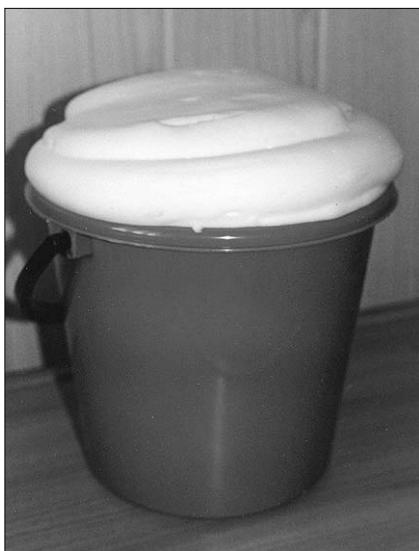
Рис. 3. Пена, полученная с использованием пенообразователя ПБ-2000
