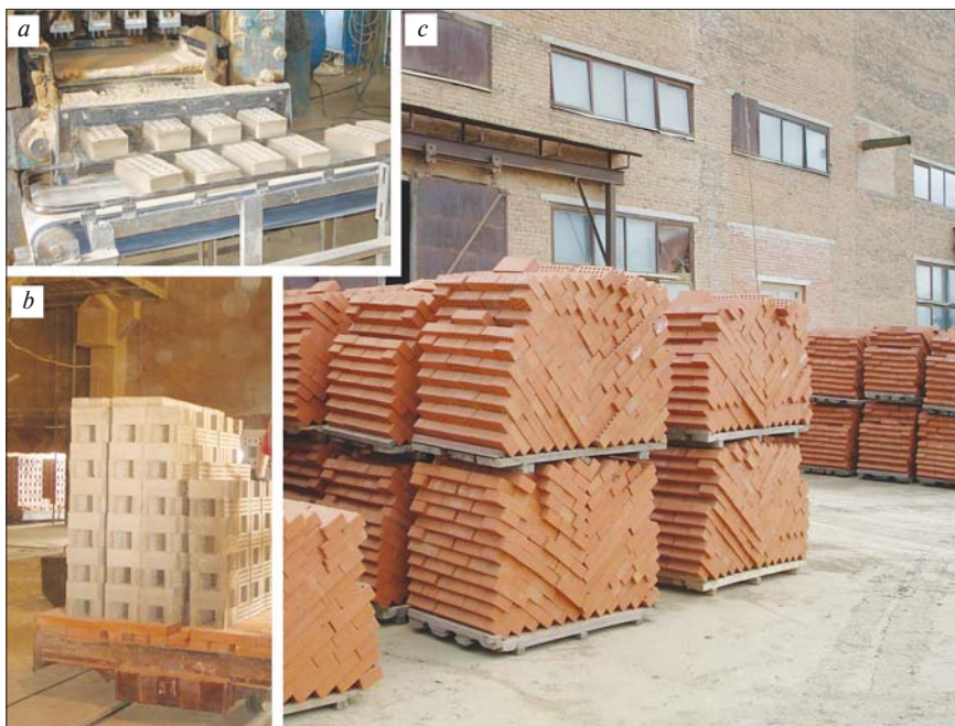
Рис. 1. Бердский кирпичный завод: а – полусухое пресование кирпича; б – высушенный сырец; с – паллеты с керамическим кирпичом
