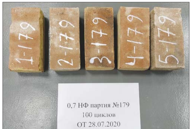
Рис. 4. Состояние дорожного клинкерного кирпича при лабораторных испытаниях на морозостойкость Fig. 4. Condition of road clinker bricks during laboratory tests for frost resistance
