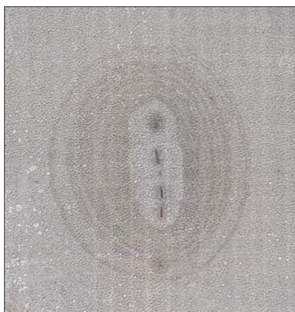
Рис. 2. Внешний вид дефектов в виде округлых пятен Fig. 2. The appearance of defects in the form of rounded specks
