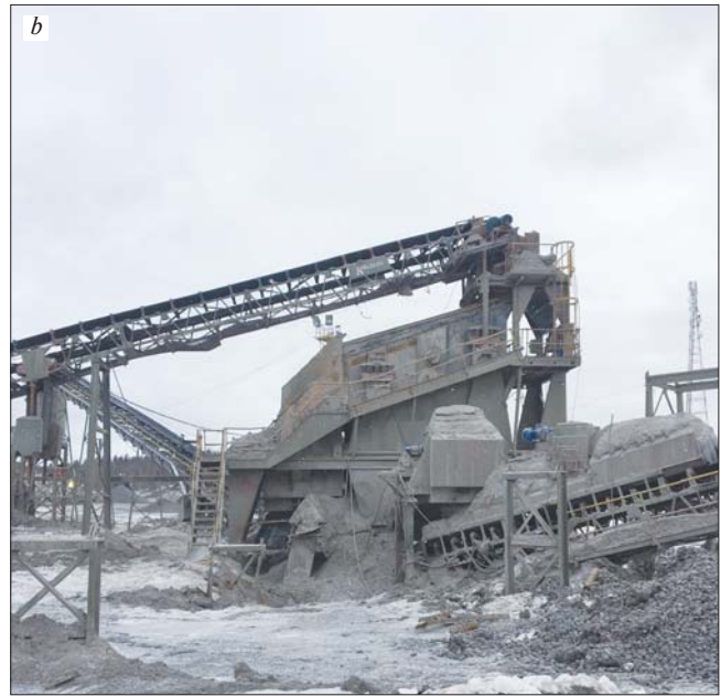
Рис. 3. Грохоты производства НПК «Механобр-техника» в составе установки Telsmith (США) на предприятии «Гранит-Кузнечное»: а – ГИС-54; б – ГИТ-72
