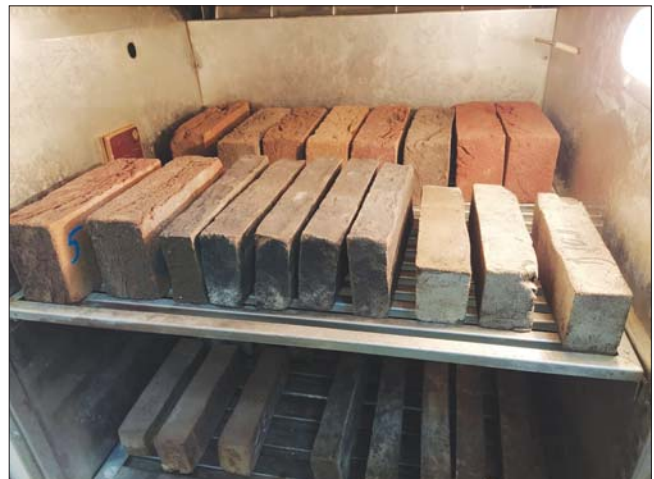
Рис. 3. Испытание дорожного клинкерного кирпича на морозостойкость по ГОСТ 7025–91 методом объемного замораживания Fig. 3. Testing of road clinker bricks for frost resistance according to GOST 7025–91 by the volumetric freezing method
