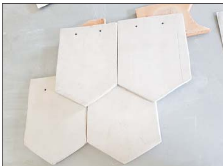
Рис. 5. Образцы керамической черепицы из аргиллитов, полученные в Донском государственном техническом университете Fig. 5. Samples of ceramic tiles from mudstones obtained at the Don State Technical University
