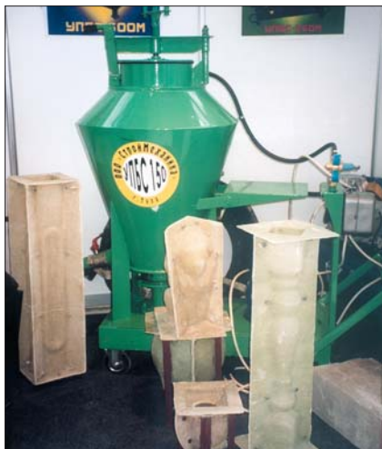
Компания «СтройМеханика» представила специалистам не только установку для производства пенобетона, но и формы для отливки декоративных изделий
