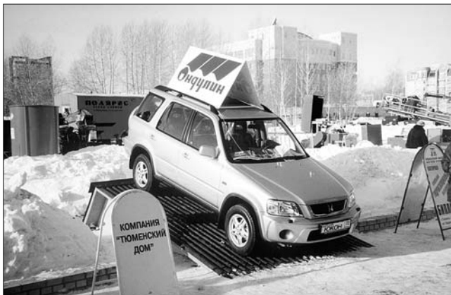
На каждой строительной выставке французский кровельный материал «Ондулин» подвергается показательным испытаниям. В Тюмени к весу автомобиля присоединились суровые сибирские морозы.
