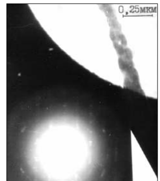
Рис. 8. Электронная микрофотография и микродифракционная картина реликтов волокна хризотил-асбеста
