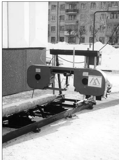
Ленточнопильный станок СЛП-600ЭС производства ОАО «Курганмашзавод»
