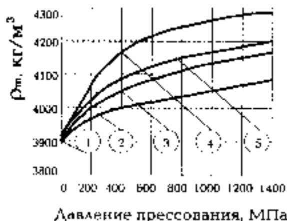
Рис. 1. Влияние давления прессования на среднюю плотность \rho_m эпоксидных композитов:
