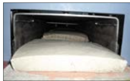
Рис. 4. Ячеистая стеклокристаллическая плита на выходе из туннельной печи при изготовлении по безопалубочной технологии
