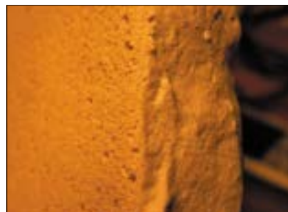
Рис. 3. Ячеистая стеклокристаллическая плита в области границы обработанной распиловкой (слева) и неизменной поверхности (справа)
