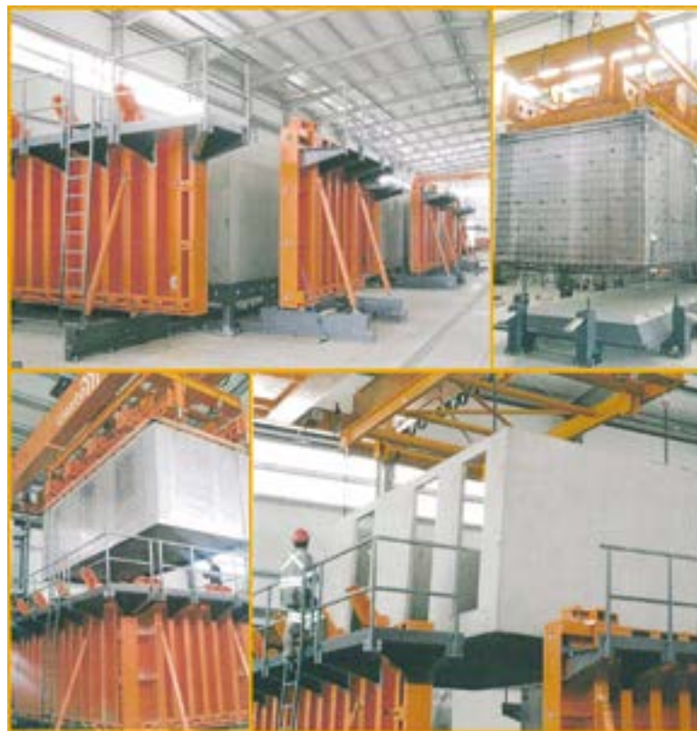
Рис. 8. Формование объемного блока по технологии *Upcrete «Ratec» ( www.ratec.org )
