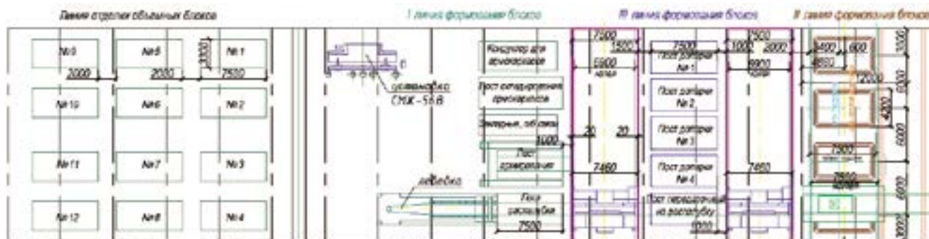
Рис. 2. Схема формовочного пролета производства объемных блоков
