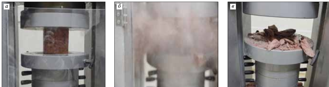
Рис. 3. Испытание образца-куба с ребром 100 мм окрашенного порошково-активированного песчаного бетона после 1000 циклов замораживания-оттаивания при предельной нагрузке 162 т: а – начало испытания образца; б – момент пылеобразования при «взрывном» разрушении; в – образец после разрушения
