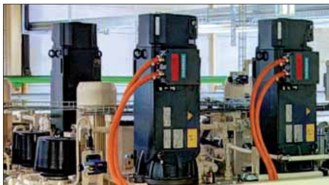
Рис. 12. Общий вид прямого сервопривода гидравлического пресса фирмы «Ласко»
