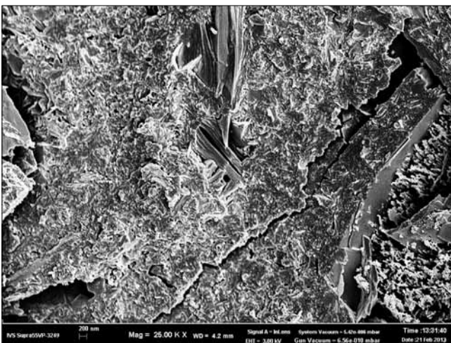
Рис. 4. Структура цементного камня в возрасте 360 сут (увеличение \times 25000 )
