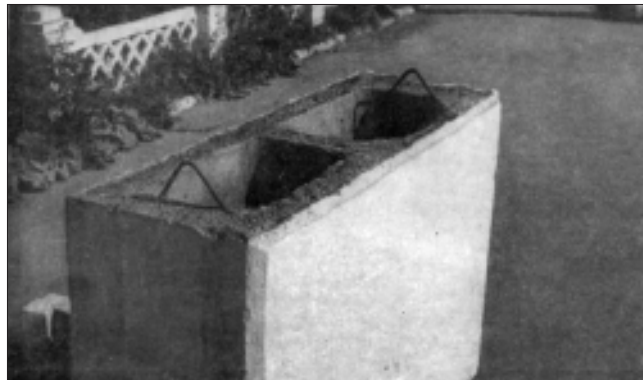
Рис. 2. Крупноразмерный двухпустотный гипсобетонный блок (1,2×0,8×0,4 м), производство треста № 3 г. Уфы в 1957–1959 гг. (1958 г.)
