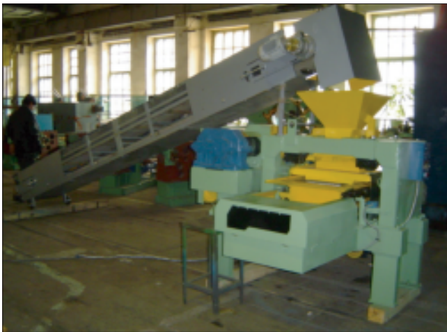
Рис. 9. Мобильная установка РК-250 для полусухого прессования стеновых изделий из различных материалов (грунтоблок, гипсоблок). Кувандыкский механический завод (Оренбургская обл.)
