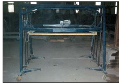
Рис. 4. Резательный комплекс: а – устройство для поперечной резки; б – устройство для горизонтальной резки; в – устройство для продольной резки
