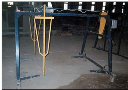
Рис. 4. Резательный комплекс: а – устройство для поперечной резки; б – устройство для горизонтальной резки; в – устройство для продольной резки
