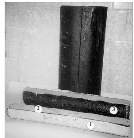
Рис. 2. Скорлупы из газозолобетона с двусторонним защитным покрытием: 1 – двухслойное наружное покрытие из стеклоткани и рулонного гидроизоляционного материала; 2 – газозолобетон; 3 – внутренний гидроизоляционный слой
