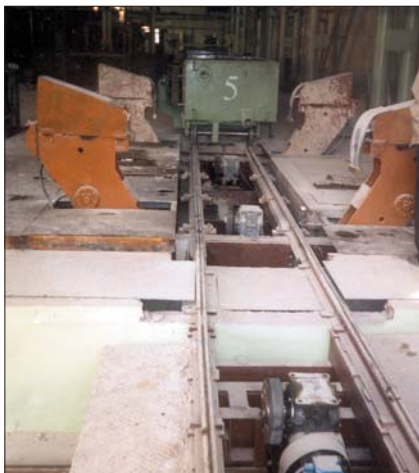
Подача формы на виброплощадку формовочного поста
