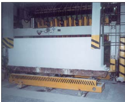
Подача автоклавированного массива под разборщик
