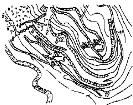
Рис. 2. Схема вскрытия рабочих горизонтов на нагорном карьере Стерлитамакского цементно-содового завода
