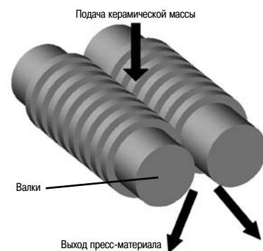
Рис. 1. Схема валков для получения пресс-материала
