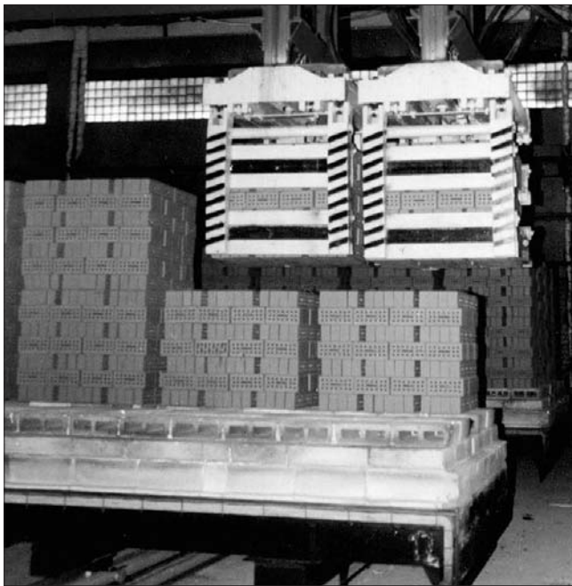
Рис. 4. Пакетная разгрузка печных вагонеток
