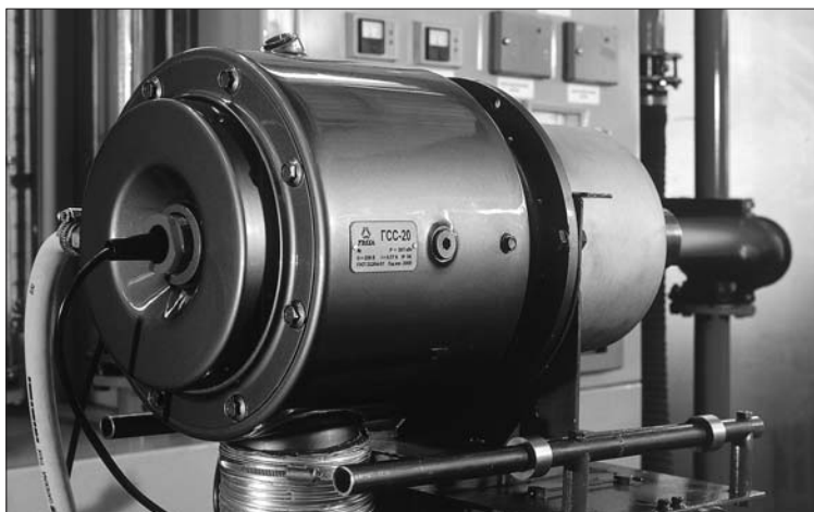
Рис. 1. Горелка ГСС-20 С (тепловая мощность 200 кВт)
