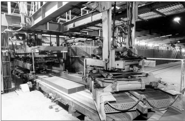
Укладка высушенного кирпича на вагонетки
