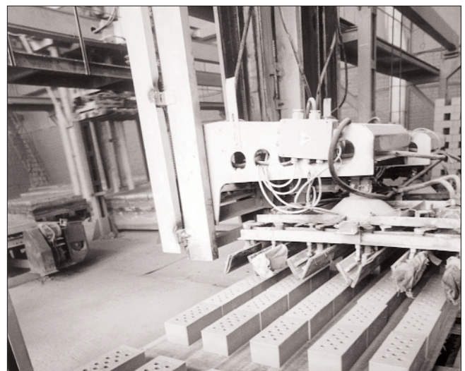
Рис. 2. Автомат-садчик сырца на обжиговые вагонетки
