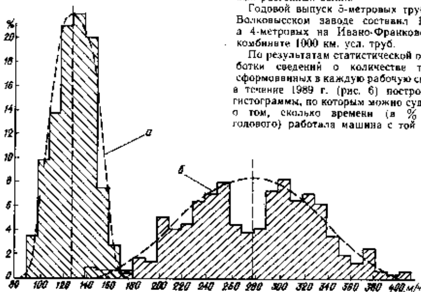
Рис. 6. Гистограммы распределения часовой производительности импортных машин для формования 4-метровых труб на Ивано-Франковском комбинате (а) и 5-метровых — на Волковическом заводе (б)
