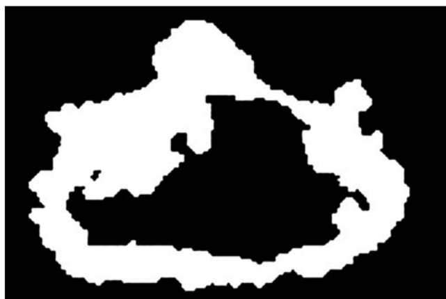
Рис. 2. Фрактальный вид обводненной частицы цемента ( \times 2000 ). Фрактальная размерность D=1,84
