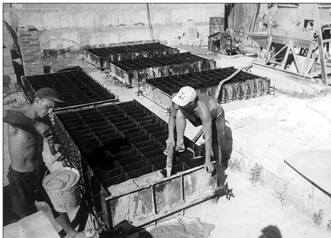
Рис. 2. Заполнение гребенчатых форм пенобетонной смесью с контролем средней плотности
