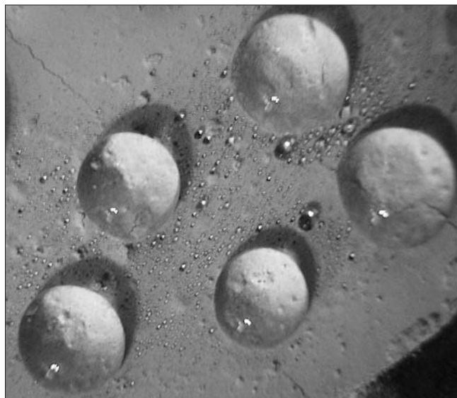
Рис. 4. Образование конденсата вокруг капель на гидрофобизированной минерально-шлаковой поверхности
