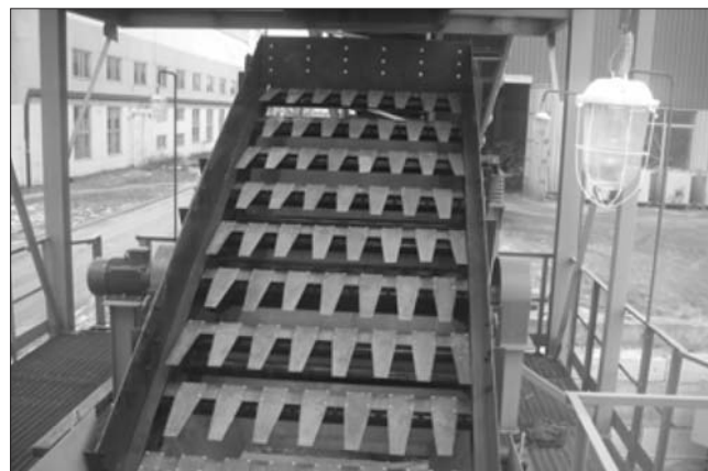
Рис. 2. Грохот «Орбитор» ГИС-61М для сепарации бытового строительного мусора
