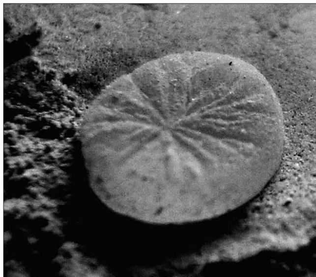
Рис. 5. Деформированная капля воды на поверхности шлакового порошка, гидрофобизированного стеаратом цинка (×7)
