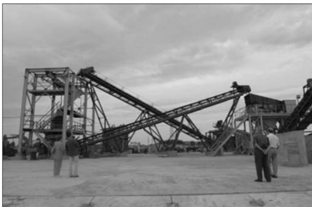
Рис. 1. Установка для получения кубовидного щебня на базе дробилки КИД-1200М и грохота ГИС-52
