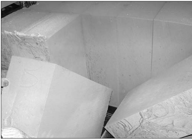
Рис. 3. Готовые блоки. Точность реза 1 мм. Высокое качество поверхности блока
