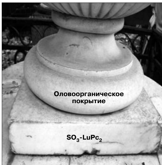
Надгробие XVIII в. из однородного каррарского мрамора в Музее некрополя Александро-Невской лавры, различные участки поверхности которого покрыты синтезированным нанокмпозиционным покрытием, легированным SO 3 -LuPc 2 , и оловоорганическим покрытием
