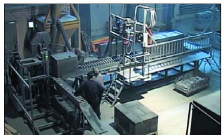
Рис. 4. Комплекс резки пеноблоков ШЛ 444 в действующем производстве
