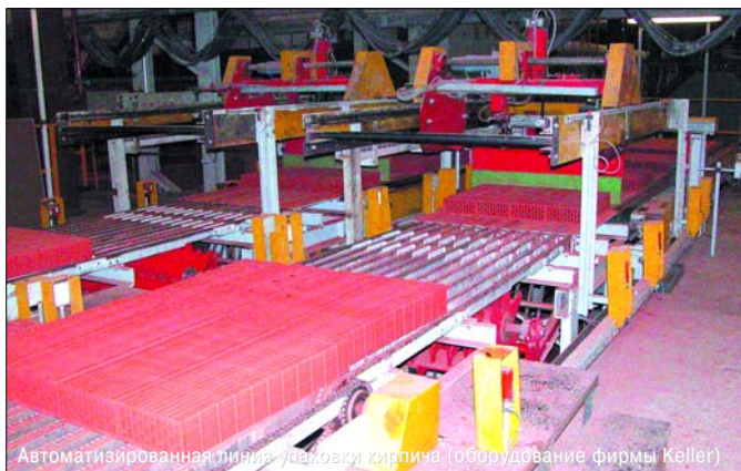
Автоматизированная линия укладки кирпича (оборудование фирмы Keller)
