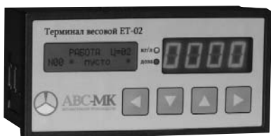
Многофункциональный весовой терминал ET-02
