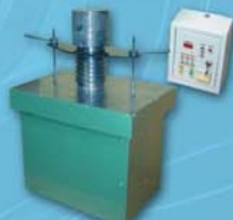
Виброплощадка ВПЛ-1АВ для формирования асфальтобетонных образцов
