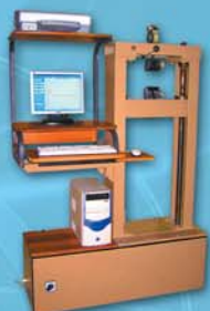
Разрывная машина модернизированная с компьютерным
