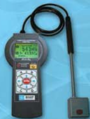
ИЗС - Измеритель защитного слоя
