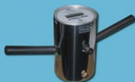
АГАМА-2РМ прибор для определения воздухопроницаемости
