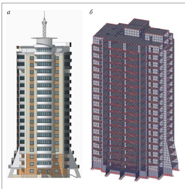
Рис. 1. Жилой 17-этажный дом: а – общий вид; б – расчетная схема первого уровня
