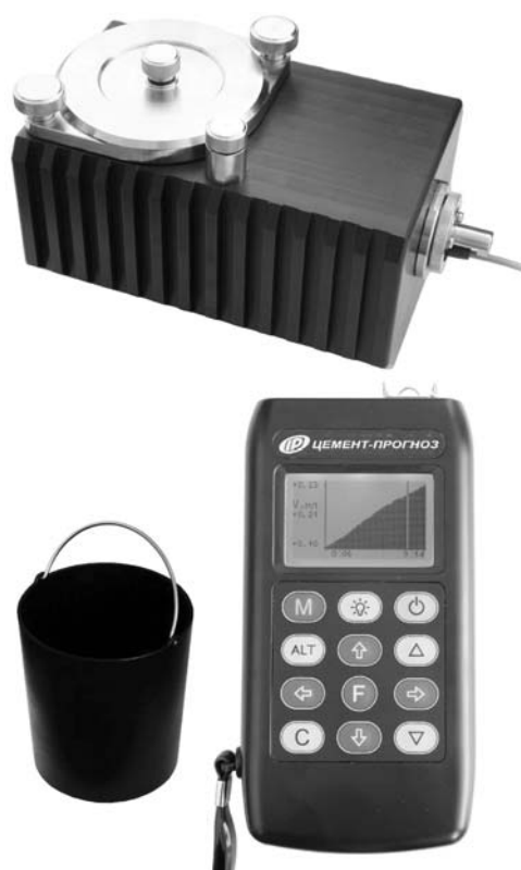
Рис. 1. Внешний вид прибора «Цемент-Прогноз»
