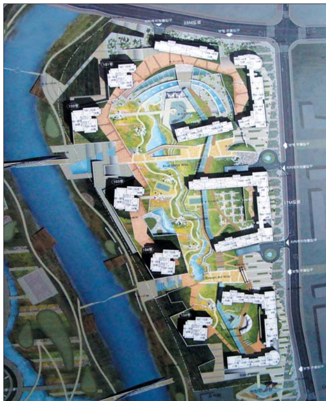
Рис. 9. Проект многофункционального жилого комплекса Р1. Предусмотрена смешанная застройка с точечными домами в 26 этажей, протяженными домами в 10, 12, 14 этажей
