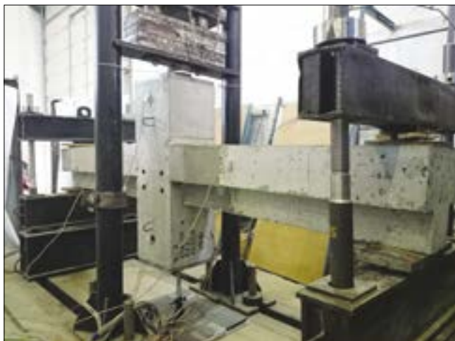
Рис. 11. Динамические испытания узла сопряжения ригелей с колонной
