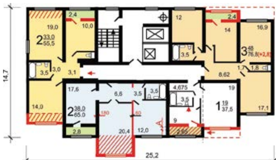
Рис. 6. Трансформируемая блок-секция «Дом НАД» в УСКПД. ВАРИАНТ-3
