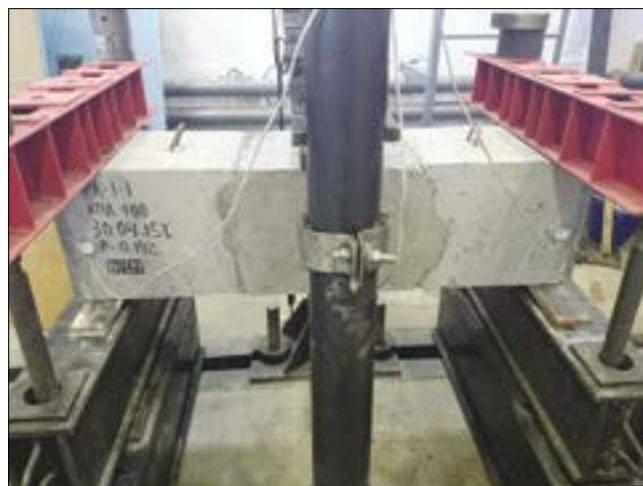
Рис. 7. Динамические испытания стыка колонн
