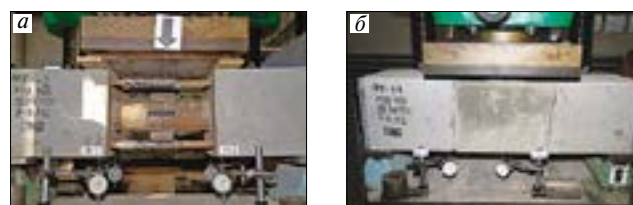
Рис. 6. Испытания стыков колонн на изгиб (поперечную силу): а – незамоноличенный стык; б – замоноличенный стык
