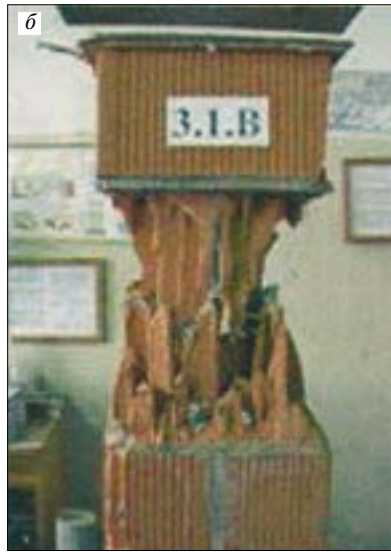
Рис. 3. Характер разрушения кладки неармированного элемента (а); области между армированными стальными сетками постельными швами (б); компрессионное раздавливание между поясами композитной обоймы (в)
