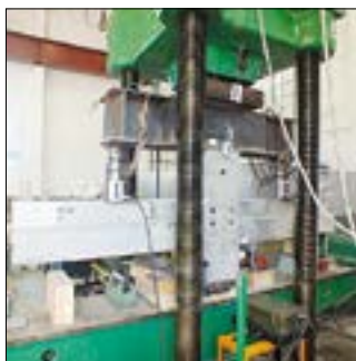
Рис. 10. Статические испытания узла сопряжения ригелей с колонной
