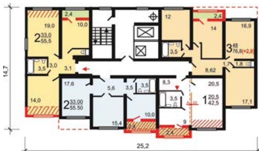
Рис. 4. Трансформируемая блок-секция «Дом НАД» в УСКПД. ВАРИАНТ-1
