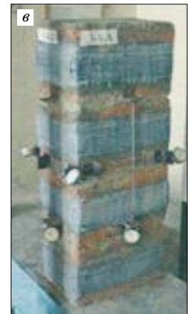
Рис. 5. Опытные образцы из керамического и силикатного кирпича, усиленные стальными (а, б) и композитными (в) обоймами
