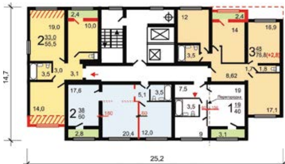
Рис. 5. Трансформируемая блок-секция «Дом НАД» в УСКПД. ВАРИАНТ-2
