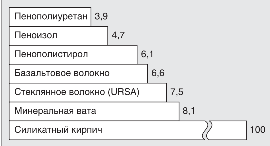
Сравнительные характеристики толщин теплоизоляционных материалов, соответствующих 100 см кирпичной кладки
