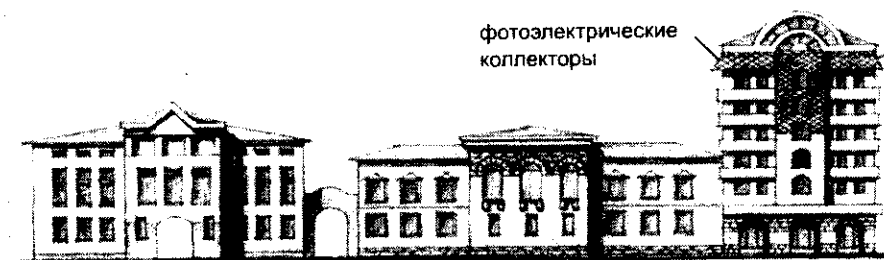
Рис. 5. Оборудование жилого дома фотоэлектрическими коллекторами после реконструкции
