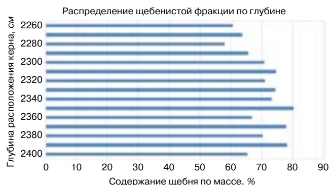
Рис. 10. Характер распределения щебенистой фракции по длине сваи
