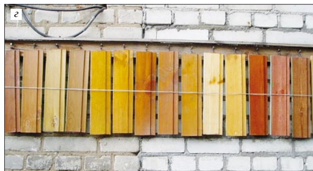
Рис. 6. Испытание атмосферостойкости защитных покрытий образцов, установленных на стендах под углом 45° к горизонту (а, в) и вертикально на стене (б, з) на полигоне ЦНИИСК
