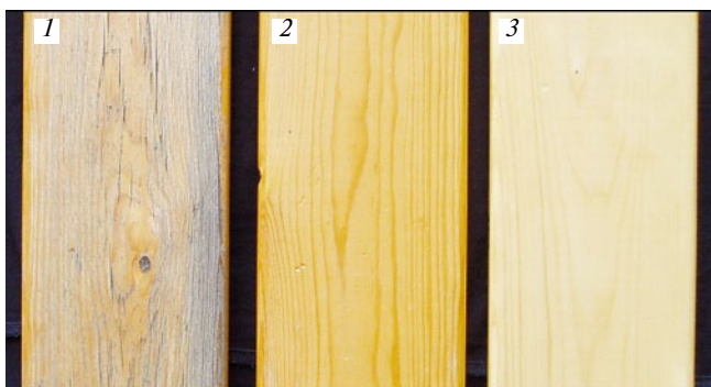
Рис. 4. Состояние образцов с покрытием бесцветным алкидным лаком (два слоя) после двух лет экспонирования на открытом воздухе: 1 – на стенде под углом 45°; 2 – на стене; 3 – контрольный
