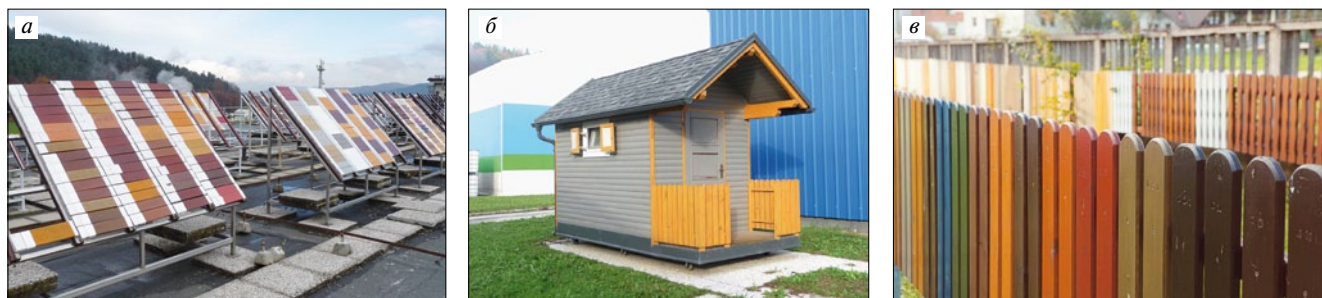
Рис. 3. Испытание атмосферостойкости лакокрасочных Пк на заводе Belinka (Словения): а – стенды с образцами, установленные на крыше; б – домик-модель, обработанный различными покрытиями; в – деревянный забор
