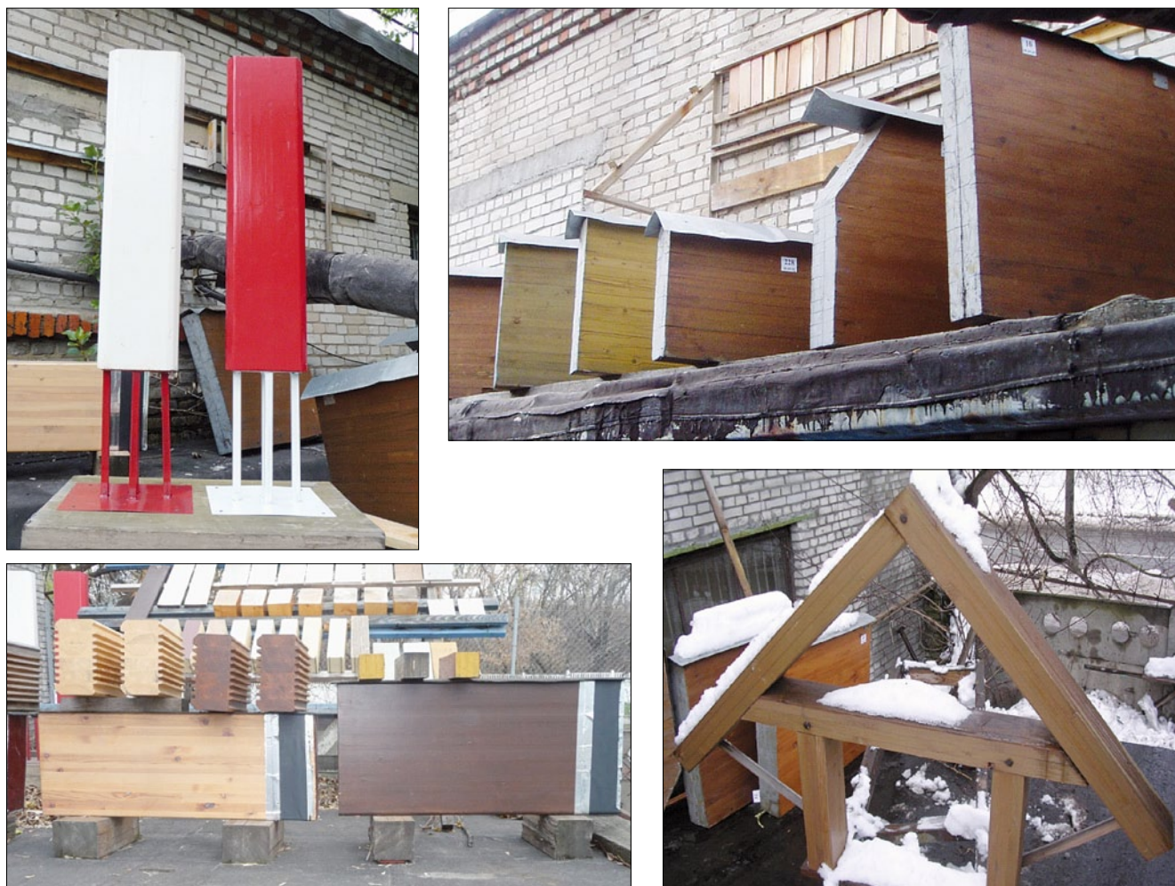
Рис. 9. Испытание атмосферостойкости защитных покрытий на фрагментах КДК (полигон ЦНИИСК)
