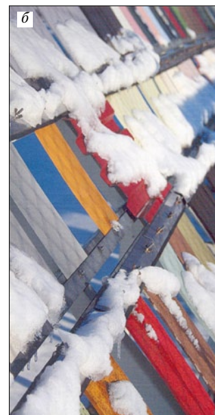
Рис. 2. Натурные климатические испытания лакокрасочных Пк в Финляндии [ГОСТ 27325–87]: а – общий вид испытательного полигона; б – образцы с Пк, установленные на стенде
