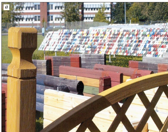
Рис. 2. Натурные климатические испытания лакокрасочных Пк в Финляндии [ГОСТ 27325–87]: а – общий вид испытательного полигона; б – образцы с Пк, установленные на стенде
