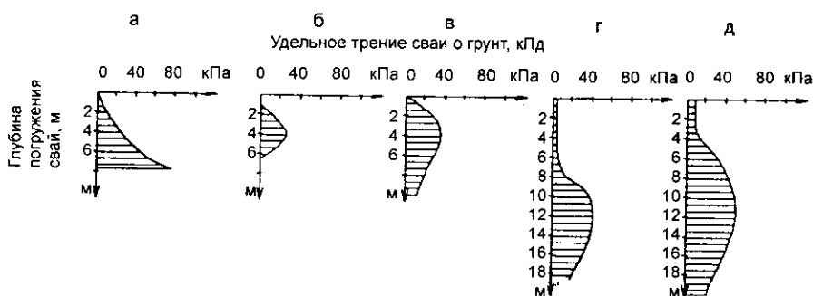
Эпюры распределения предельных сил трения грунта по боковой поверхности забивных свай
