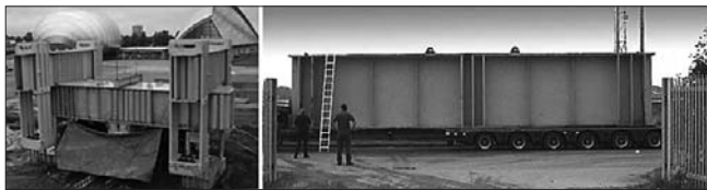
Рис. 1. Анкерная конструкция для статического испытания свай на нагрузку 3000 т
