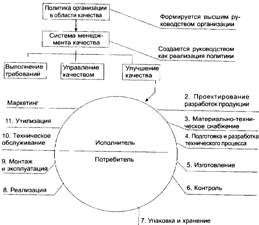
Рис. 2. Процессы жизненного цикла продукции в соответствии с политикой организации в области качества (ИСО 9001:2000)
