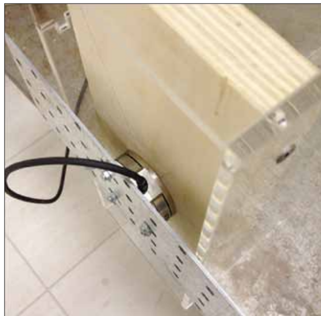
Рис. 5. Монтаж сило-моментных датчиков
