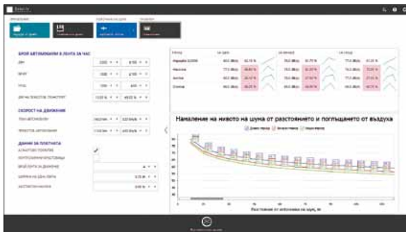
Рис. 2. Определение шумовой характеристики от источника шума (автомобильный поток) с помощью софтвера Urban Acoustics и вероятностным анализом по методу «Монте Карло»
