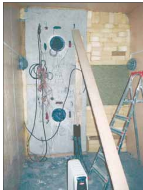
Рис. 6. Общий вид испытаний по определению приведенного сопротивления теплопередаче
