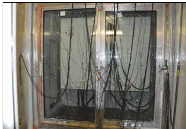
Рис. 1. Внешний вид образца с датчиками температуры и тепловых потоков, установленного в проем климатической камеры КТК-2009
