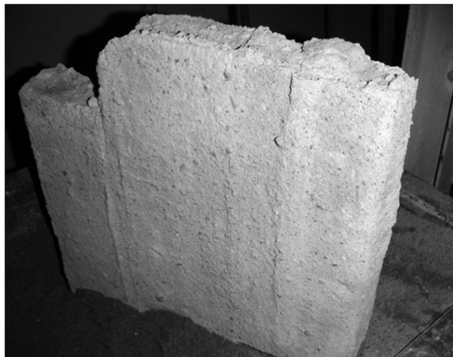
Рис. 2. Отформованная бетонная «стена в грунте»
