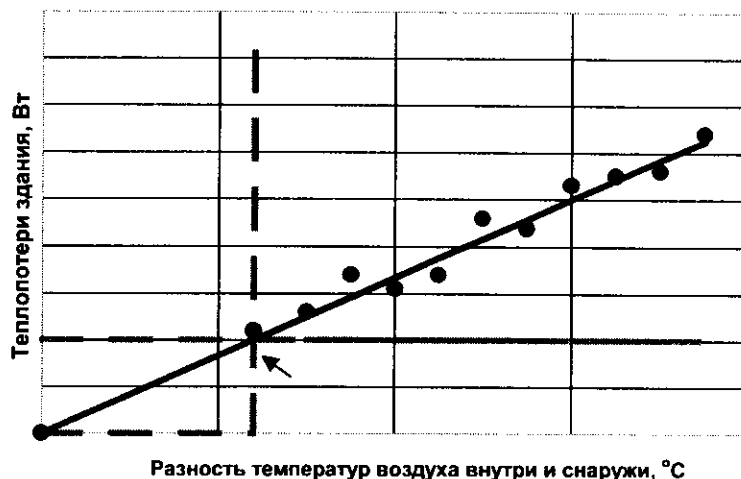
Рис. 2. Схема функциональной зависимости теплопотерь здания от разности температур воздуха внутри и снаружи
