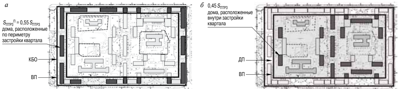
Рис. 10. Использование первых этажей квартала для нежилых функций: а – в периметрально расположенных домах квартала; б – в домах, расположенных внутри застройки квартала
