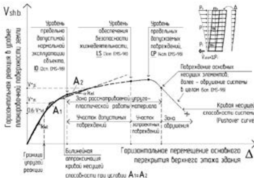
Рис. 3. Графическая визуализация зависимости «горизонтальная сейсмическая реакция – перемещение верхней точки системы» с участками, характеризующими степень повреждения несущих конструкций
