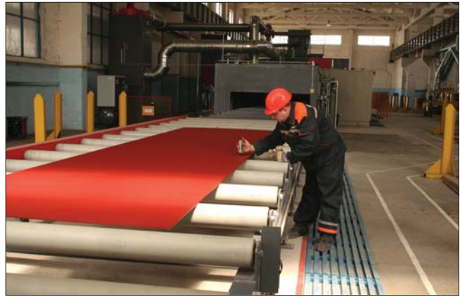
Рис. 3. Линия дробеметной очистки и грунтовки проката
