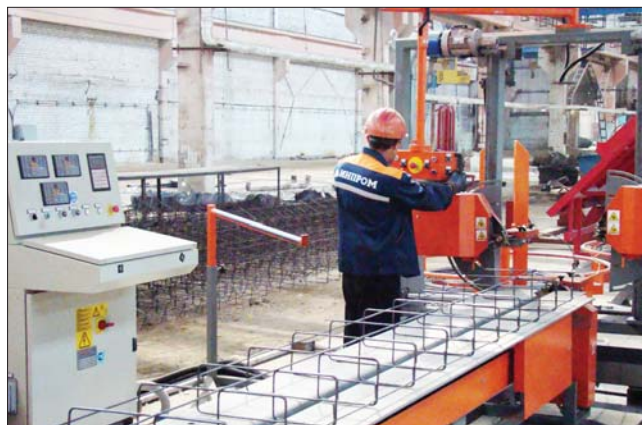
Рис. 4. Изготовление каркаса в ОАО «ИНПРОМ»
