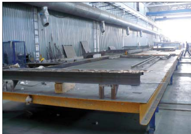
Рис. 2. Паллеты с переставными бортами длиной 9 м
