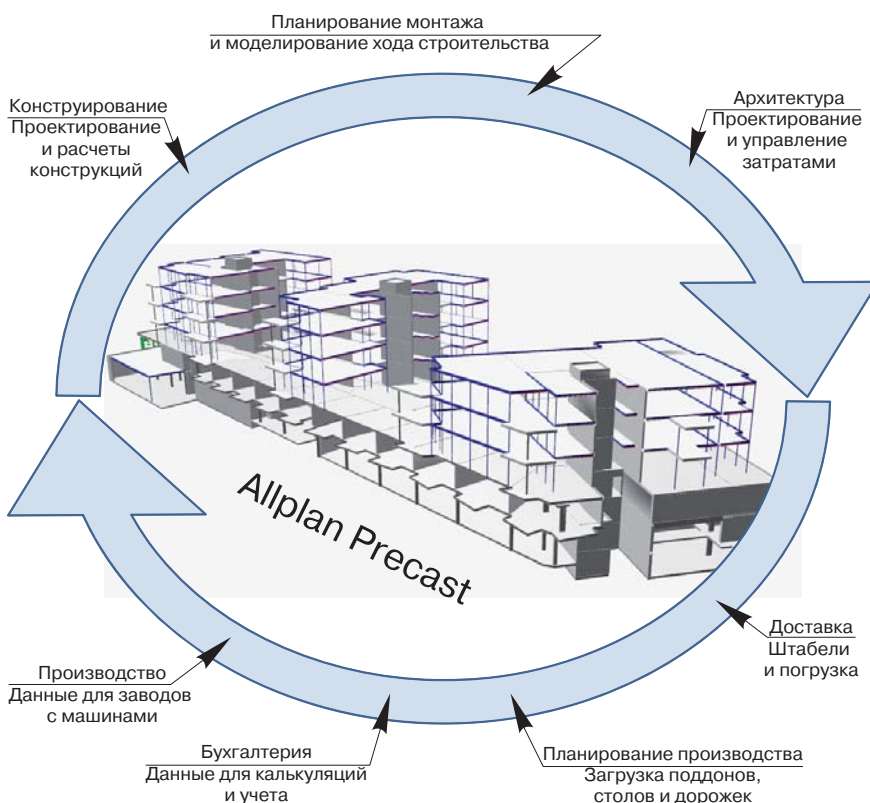
Рис. 1. Система Allplan Precast с приложениями, банком данных и информации для сооружений и сборных элементов
