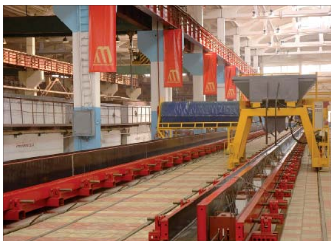
Рис. 3. Стенд полигонного типа для выпуска изделий сборно-монокристаллического каркаса (Санкт-Петербург)
