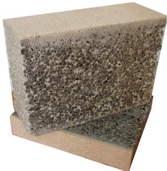
Рис. 2. Стеновой блок, созданный по наливной технологии с фактурным и штукатурным слоями
