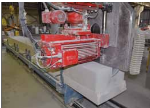
Установка сухой резки перемычек
