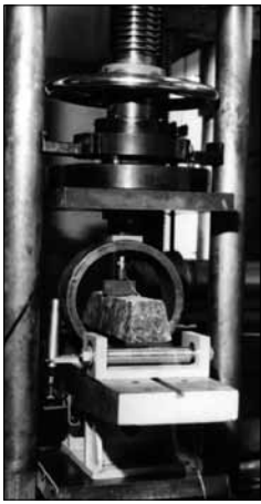
Рис. 3. Установка для получения полностью равновесных диаграмм деформирования и разрушения – ПРДД
