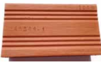
Кирпич после помола глины до 250 мкм. Все карбонаты исчезли
