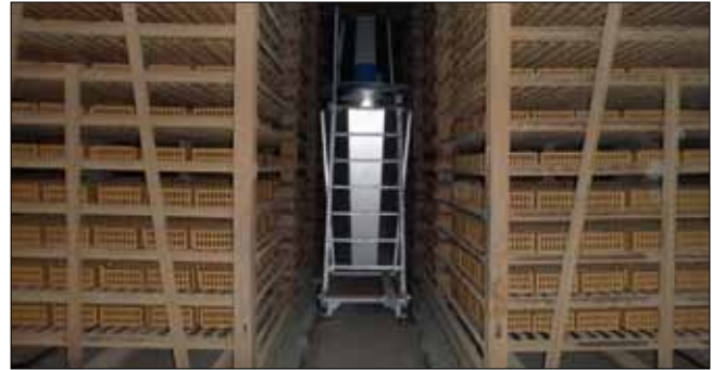
Рис. 2. Модернизированная сушилка с установленным вентилятором MT45
