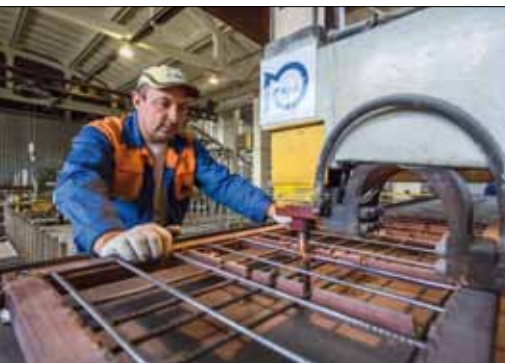
Сваривание плоских сеток
