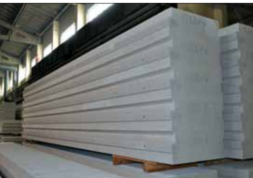
Панели перекрытий после автоклавной обработки
