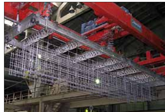
Арматура с нанесенной антикоррозионной обмазкой
