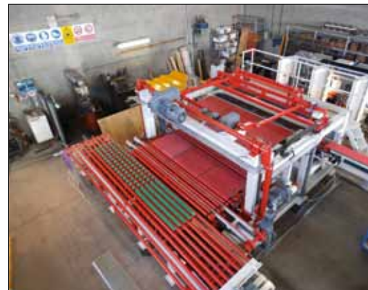
Многострунный резчик сверх высокой производительности в момент предварительных пусконаладочных работ на предприятии «Маркелуццо Импианти» (вид сверху)
