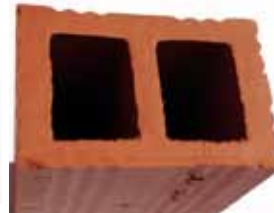
Кирпич после помола глины до 250 мкм. Все карбонаты исчезли
