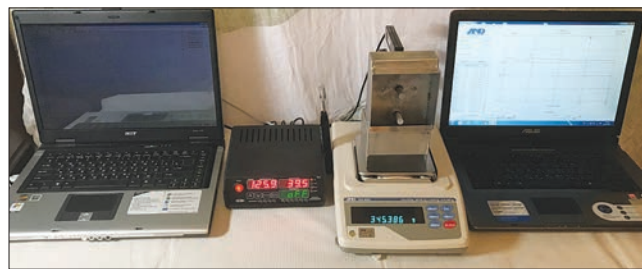
Рис. 5. Общий вид устройства для определения коэффициента паропроницаемости вертикально расположенного образца Fig. 5. General view of the device connected to computers
