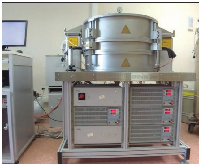
Рис. 2. Испытание теплопроводности на приборе GHP 456 Titan Fig. 2. Heat conductivity test applying machine GHP 456 Titan
