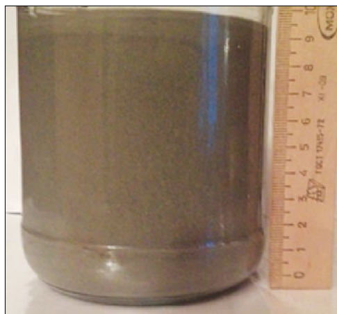
Рис. 2. Смешение битумной суспензии и взвеси распределенной в воде фибры Fig. 2. Mix of bitumen suspension and fiber distributed in water
